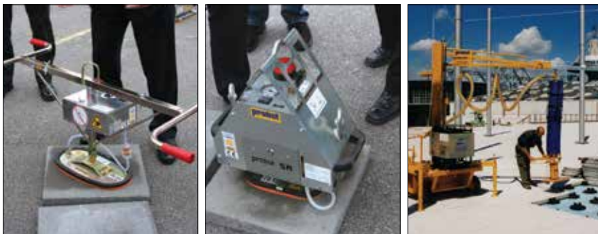
Figur 3.66. Yderst til venstre en lille batteridrevet vakuumløfter. I midten en vakuumløfter der monteres på f.eks. en gravemaskine og drives af dennes hydraulik. Yderst til højre en selvstændig vakuumløfter med stort luftflow. Det er typisk kun de sidste to typer der kan være anvendelige til betonfliser.
