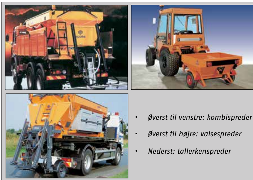
Figur 4.19. Salt kan principielt spredes på tre måder, som tørt salt, fugtet salt eller som saltopløsning. Øverst til højre ses en mindre valespreder til tørt salt, øverst til venstre en kombispreader der kan sprede både fugtet salt og en saltopløsning og nederst en traditionel tallerkenspreder til både tørt og fugtet salt.
