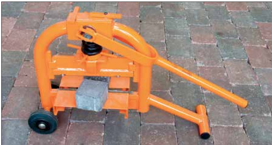
Figur 3.30. Betonsten og -fliser kan enten skæres eller klippes når de skal tilpasses.
