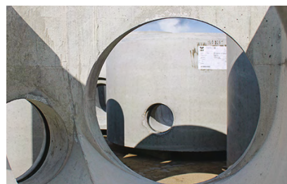
Eksempel på vådstøbt beton
