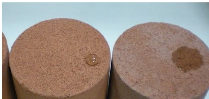
Figur 78 – Jordfugtig beton med vandafvisende behandling (tv.) og uden behandling (th.) [50].
