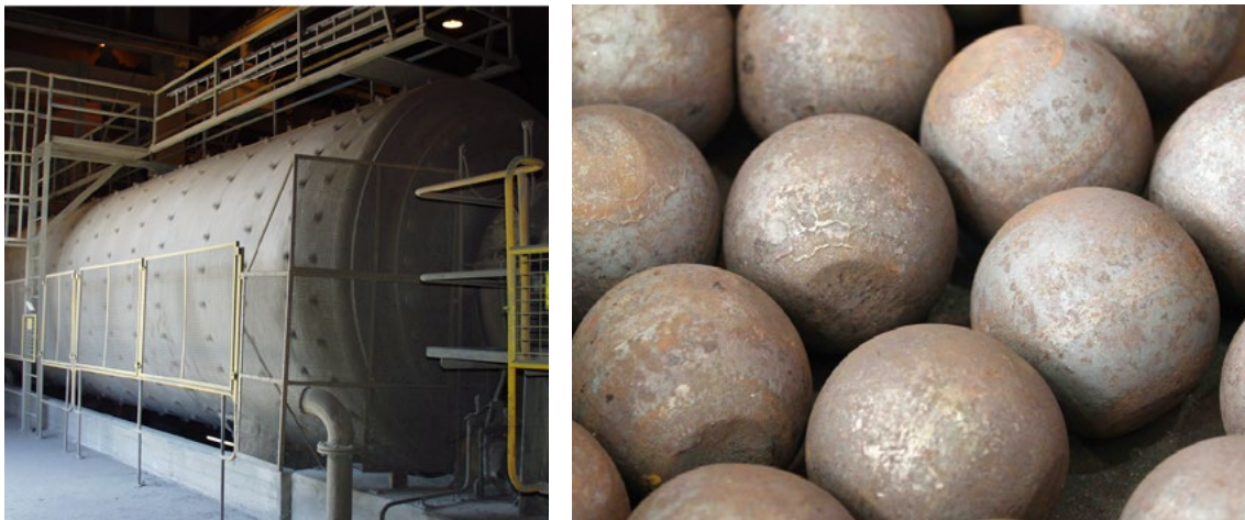
Figur 72 – Eksempel på kuglemølle (tv.) og malelegemer af legeret stål (th.)
