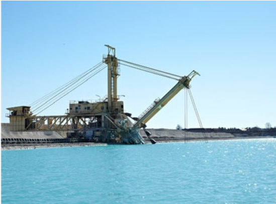
Figur 70 – Udvinning af kridt med skovthjulsgraver (th.) og dybdegraver (tv.)
