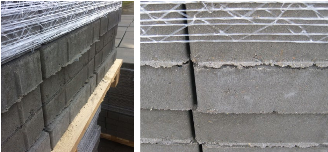
Figur 88 – Eksempel på fødder i betonvarerproduktionen.
