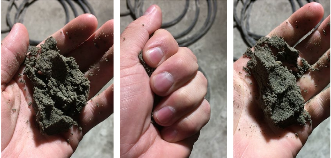
Figur 24 – Eksempel på komprimering og formstabilitet af jordfugtig beton
