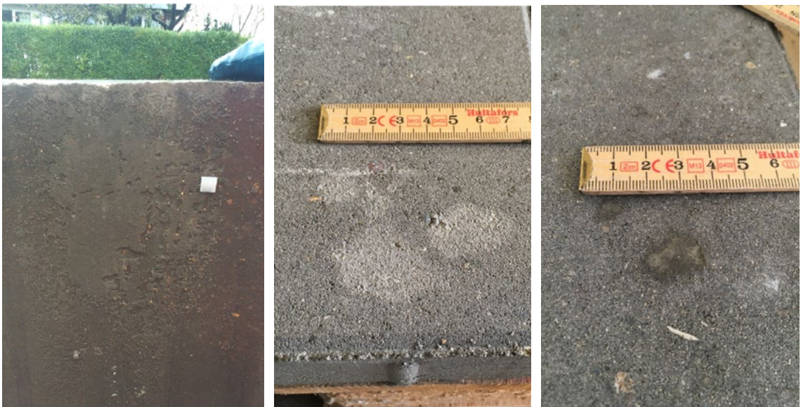
Figur 94 – Eksempler på betonrester observeret på produkter. Nogle rester hæfter sig på produktet (tv.), mens andre indstøbes i ny beton (mf. og th.), mens andre indstøbes i ny beton (mf. og th.).
