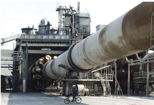
Figur 71 – Eksempel på rotér ovn (tv.) og formation af portlandcementklinker i brændezonen (th.)
