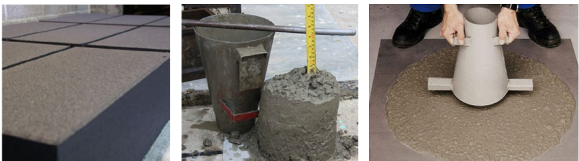
Figur 18 – Eksempler på konsistens kategorier. Tv. Jordfugtig støbt beton; Mf. Sætmålsbeton; Th. SCC
