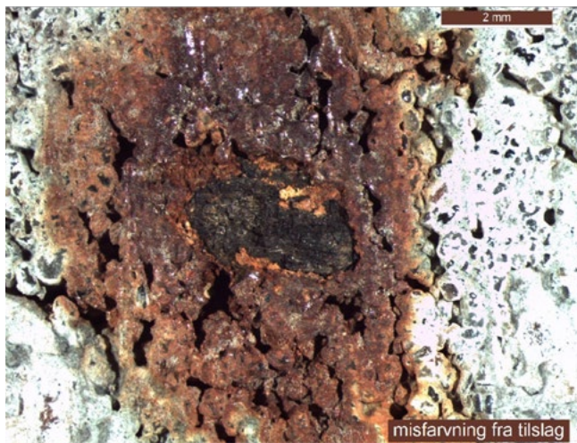
Figur 124 – Eksempel på jernholdig tilslagspartikel i overfladen.
