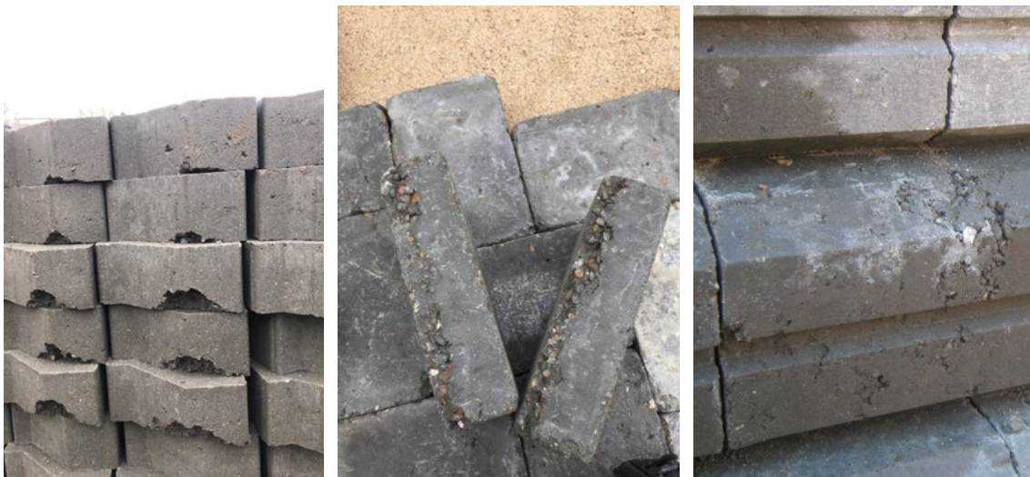
Figur 93 – Stenreder observeret i forskellige betonvareprodukter.
